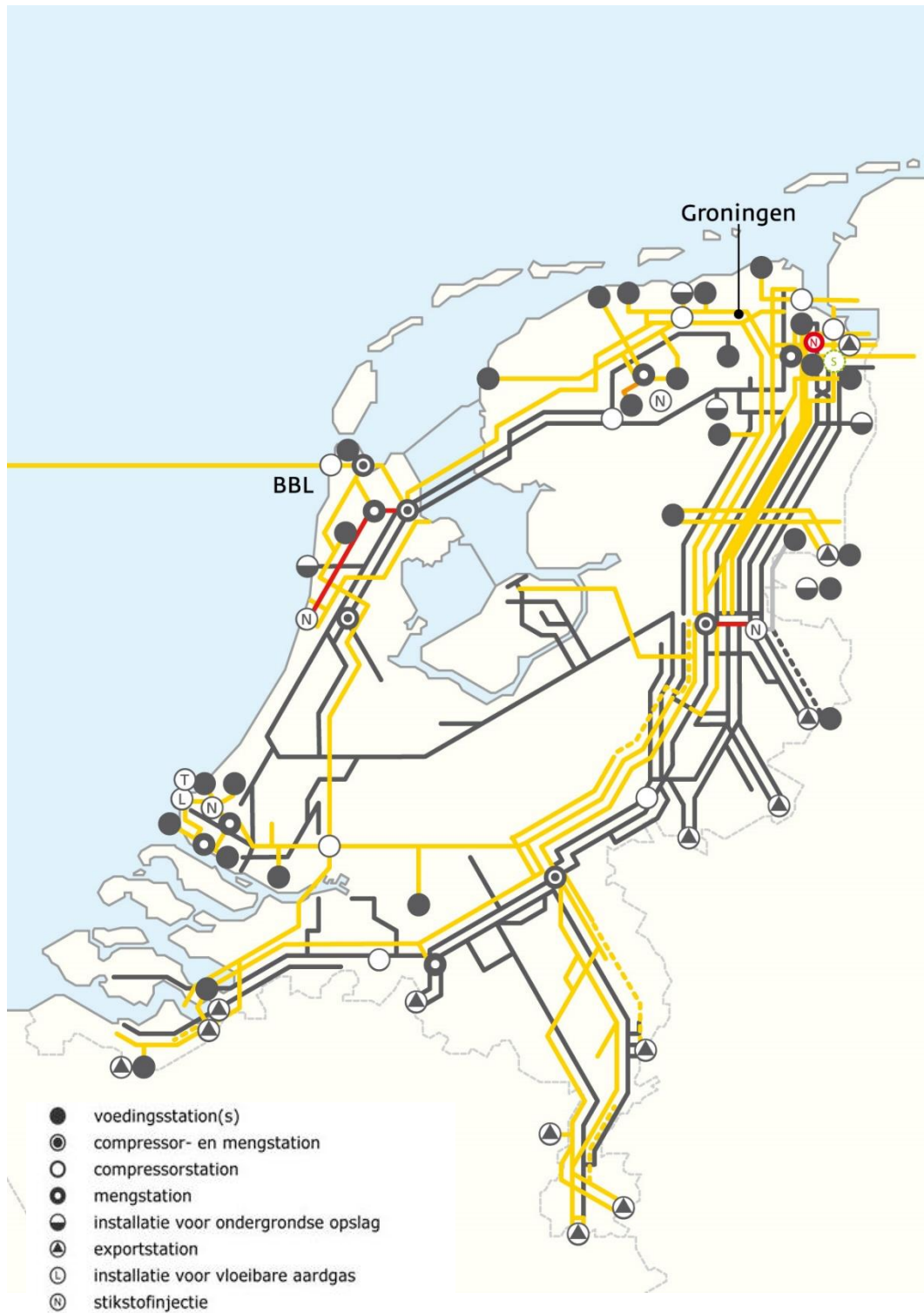
Figuur 2.3 Schematische kaart van het leidingsysteem van GTS*
